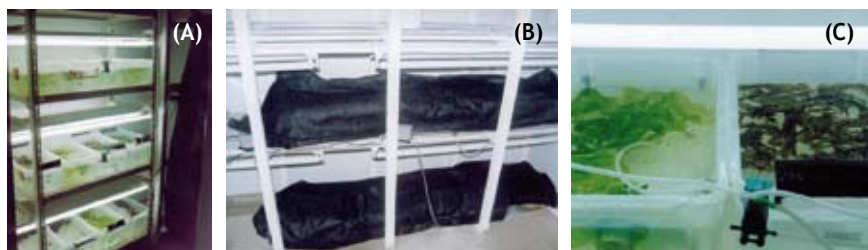
Figura 2.1. Disposición de las cubetas durante los experimentos: (A) en presencia de luz, (B) de oscuridad. Además todas las cubetas se mantuvieron con aireación constante (C).
